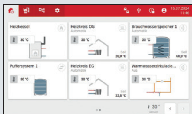
Übersicht der installierten Anlagen in Kacheldarstellung
